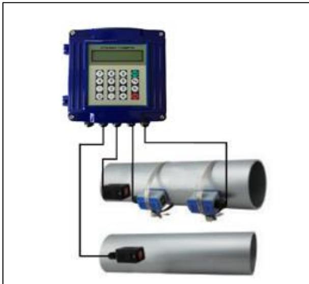
RIF 600 W prodotto dalla RIELS. Il RIF 600 W funziona grazie ad un segnale ultrasonico inviato e ricevuto attraverso il fluido in transito da una coppia di trasduttori collocati sulla tubazione in posizione definita dallo strumento stesso in funzione dell'applicazione.
